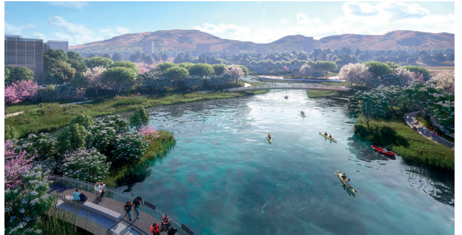
Resim 4. Eski kano/kayık olimpik alanının yeniden işlevlendirilmesi ile oluşturulan 1,5 hektarlık (3,7 ake) gölet yağışlı mevsimde suyu topluyor ve depoluyorken, kurak mevsimde de geri kazanılmış su ile buharlaşmayı dengeliyor.
